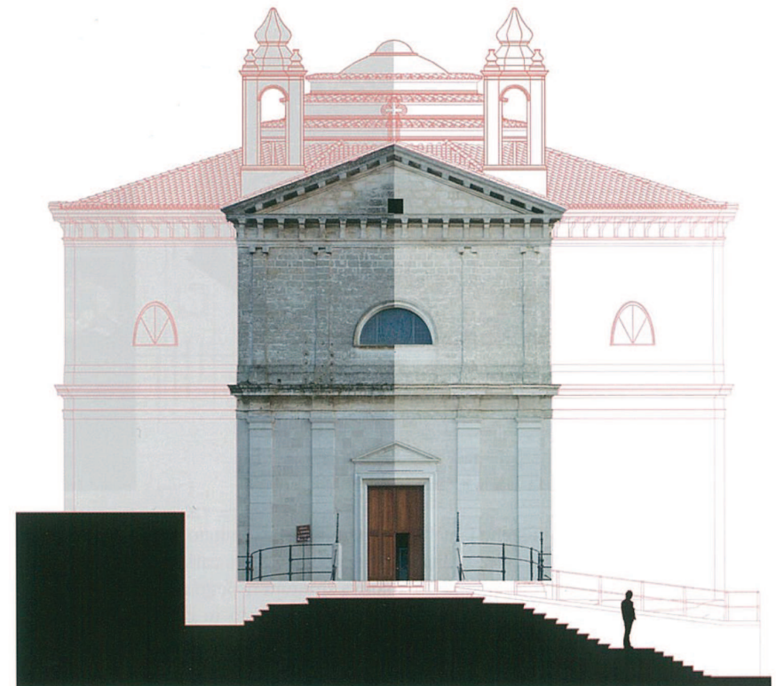
Figura 5.76. Simulazione dell'intervento di restauro sulla facciata principale
